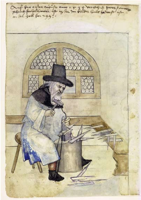
Traditionelles Handwerk: der Nürnberger Feilenhauer Peter Bauernschmied im Jahr 1534. „Ein guter Feilenhauer bewältigte im 19. Jh. bei 80 bis 220 Schlägen pro Minute bis zu 50 Feilen am Tag“ (Wikipedia).
